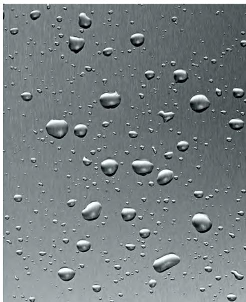
La direzione di finitura del rivestimento dovrebbe svilupparsi in senso verticale, per facilitare l'azione autopulente. Il deflusso dell'acqua porta via le particelle e riduce l'aderenza dello sporco. Foto: Outokumpu, Espoo (FIN)
