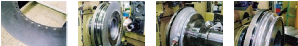
Imbutitura al tornio del cerchio esterno in acciaio inossidabile. La resistenza dell'acciaio inossidabile aumenta durante la formatura, offrendo un' interessante capacità di assorbimento degli urti
