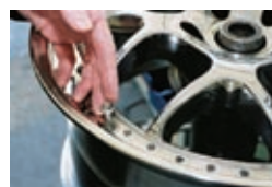
Montaggio del mozzo a stella sul cerchio interno attraverso il cerchio esterno.
