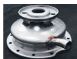
Fasi di produzione della carcassa: imbutitura profonda, idroformatura, trapanatura e molatura, montaggio raccordi
