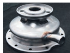
Productiestadia van het pomphuis: diepdrukken, hydroforming, boren en bewerken, aanbrengen hulpstukken
