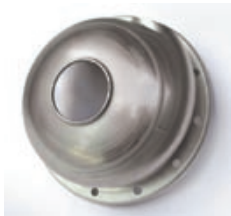
Pomphuis vervaardigd uit een diepgetrokken roestvast stalen schijf. De ingang bevindt zich aan de voorzijde en de vloeistof verlaat het pomphuis door een opening (gerealiseerd door hydroforming) aan de bovenzijde.
