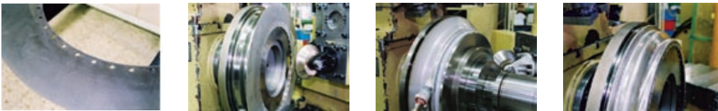
Forceren van de roestvast stalen buitenvelg. Tijdens het vervormen verstevt het roestvast staal, hetgeen een interessant potentiëel voor schokabsorptie inhoudt.
