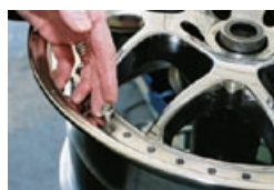
Ekernavet monteras genom den rostfria ytterfälgen mot den inre fälgen
