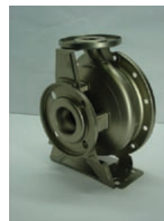
Pumphus av djuppressat rostfritt stål
