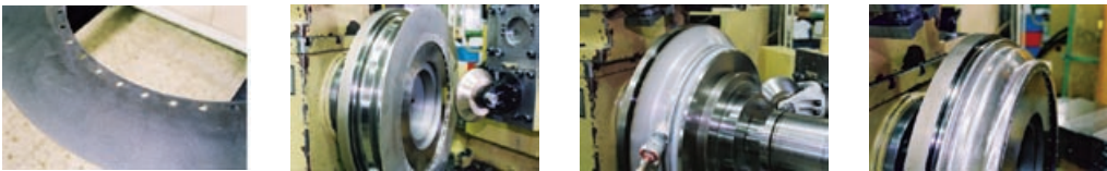
Trycksvarvning av den yttre fälgen. Det rostfria stålets hållfasthet ökar under formningen, vilket ökar förmågan att absorbera stötar.
