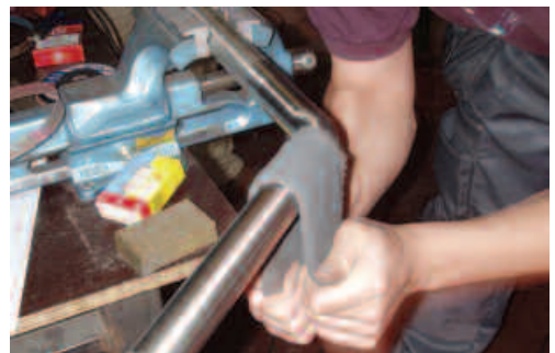
Käsikiillotusta, jolla yhtenäistetään viimeistely kahden putken välillä.
