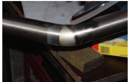
Liitoksen koko ympäristö voidaan esikäsitellä pelkästään liuskakiekkotyökaluilla
