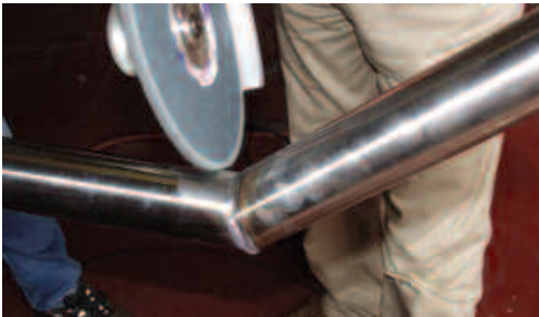
Sisäkulman käsittely sisäkulman viimeistelytyökälulla
