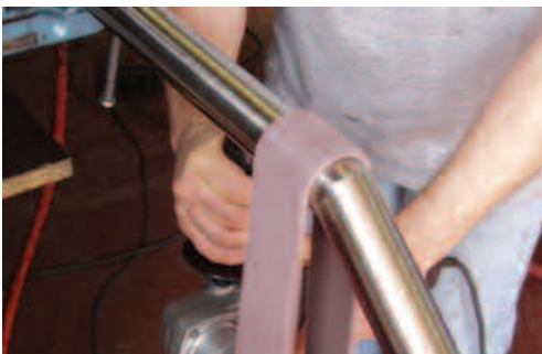
Viimeistelyä helpokäyttöisellä käsityökoneella. Liitoksen terävä kulma on vielä näkyvissä mihin hitsi on täysin hävinnyt.
