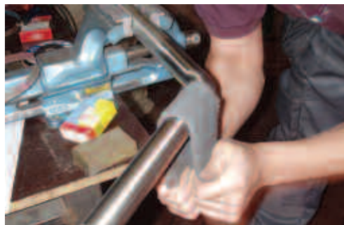
Finitura a mano per uniformare l'aspetto dell'intera ringhiera rendendo levigato il punto di collegamento tra i due tubi
