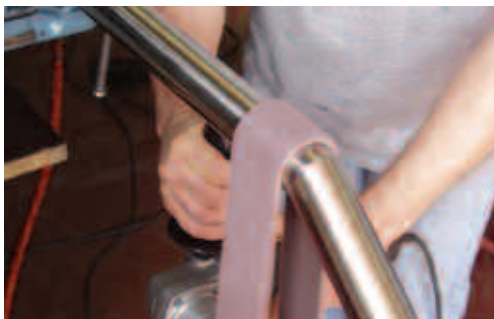
Operazione di finitura con macchina utensile portatile di facile utilizzo. L'angolo acuto del giunto è ancora visibile con la saldatura completamente uniformata
