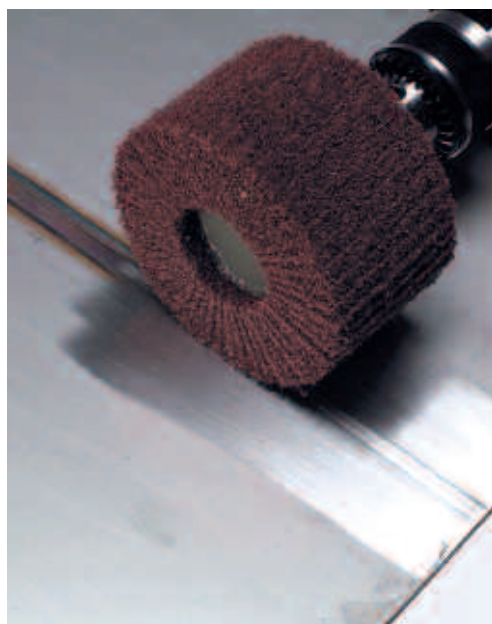
Esempio di dischetto lamellare tipo Scotch-Brite™. In questo caso, il dischetto Scotch-Brite™ spazzola la zona interessata dall’alterazione cromatica, dovuta al calore della saldatura, per uniformare il giunto saldato al metallo circostante. Questa operazione di finitura non viene eseguita allo scopo di appiattire il giunto. Per fare ciò sarebbe necessario eseguire prima un processo di molatura.
