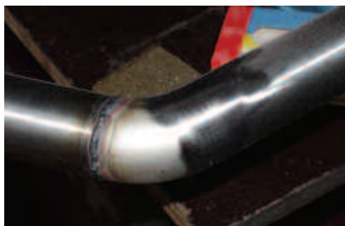
Obetydlig skarp innervinkel
