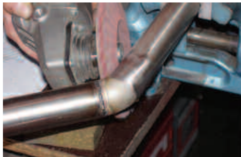
Vinkeln skapad genom förformat rör
