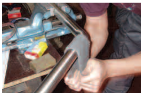
Slutlig manuell polering utav fogen skapar ett homogent handräcke med enhetlig ytstruktur.
