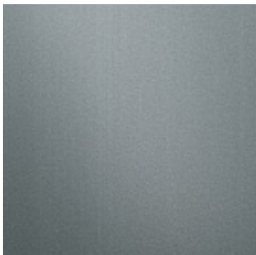
Kylmävalssaamalla valmistettuja mattapintoja
