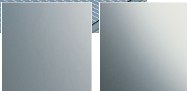
Tehdasvalmiit pinnat 2B (oikealla) ja 2R (vasemmalla)
