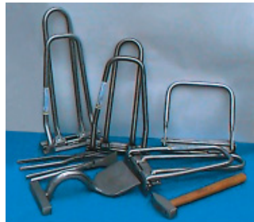
Ruostumattomia teräs-kattoja voidaan valmistaa tavanomaisilla työkaluilla edellyttäen, etteivät hiili-teräsjäämät pääse kosketuksiin ruostumattoman teräksen kanssa.
