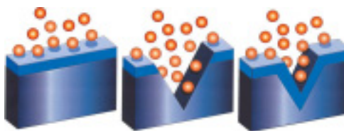
Ruostumattoman teräksen pintaan muodostuu näkymätön suojaava kalvo. Vaurioituessaan se korjautuu itsestään ilmasta tai vedestä peräisin olevan hapen vaikutuksesta.
