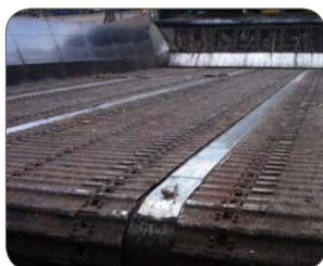
Nuance 1.4003/410, Columbus, Afrique du Sud. Cette machine est en service depuis 22 ans.
