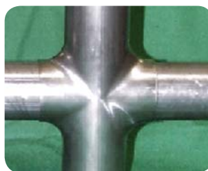
Tube soudé hydroformé en 1.4003.
