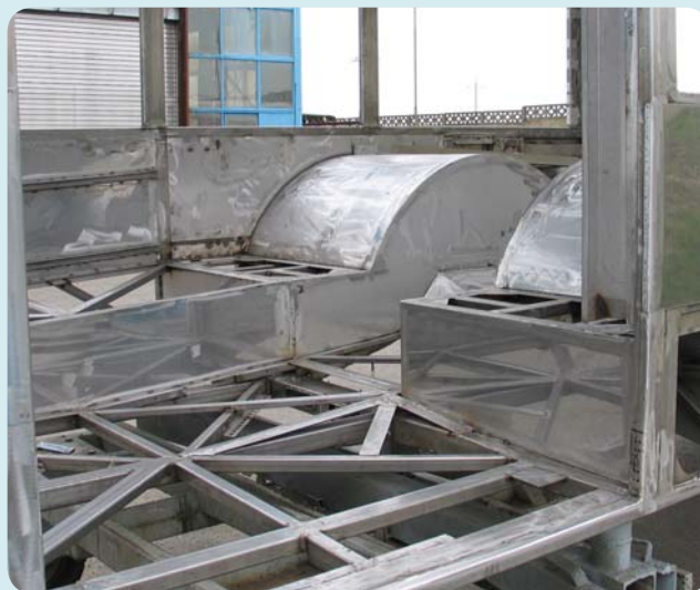
Ossature de bus soudée en nuance 1.4003.
