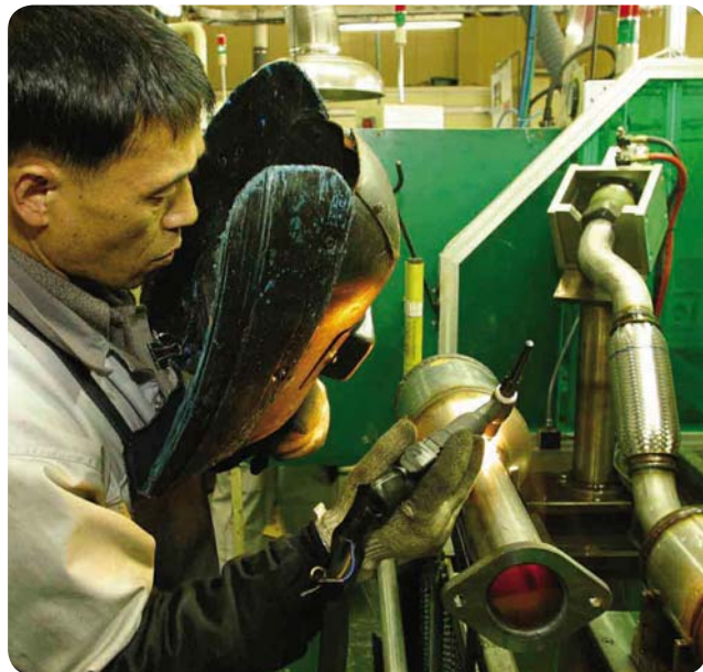
Soudage de système d'échappement en nuance 439, Corée du Sud.
