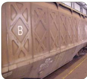
Nuance 1.4003/410 (panneaux), Columbus, Afrique du Sud. En service depuis plus de 20 ans.
