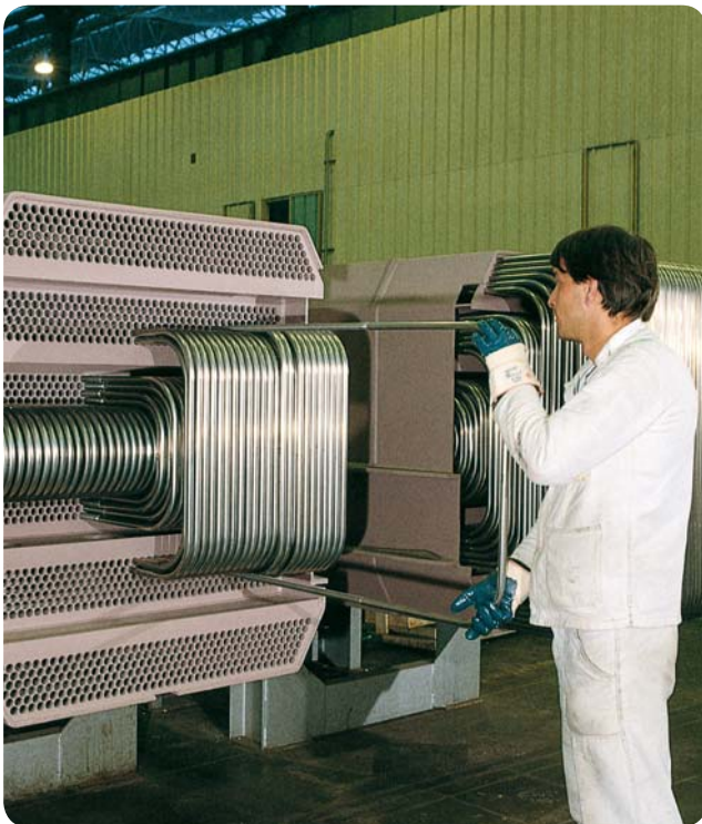
Tubes de condenseur-réchauffeur en nuance 439, Europe.
