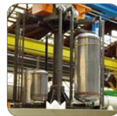
Réservoir soudé en nuance 444, Europe.
