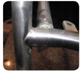
Tubes en nuance 441 soudés par brasage.
