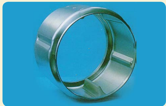
Tambour de sèche-linge en 409 soudé, formé par expansion.
