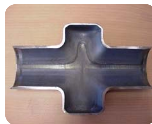
Déformation de la soudure (1.4003)
