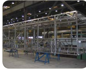
1.4003 (410), geschweißte Rohre und Platten, Solaris Bus & Coach Co., Polen
