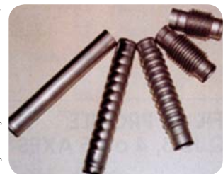
Biegen eines geschweißten Rohrs aus 1.4520 (430Ti).
