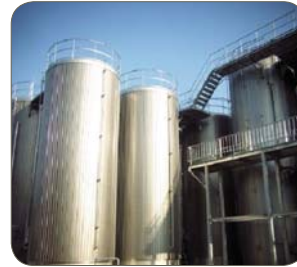
SUS430J1L (1.4016/430), farbig kunstharzbeschichtete Außenverkleidung, JSSA, Japan
