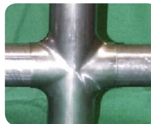
Hydrogeformtes geschweißtes Rohr (1.4003).
