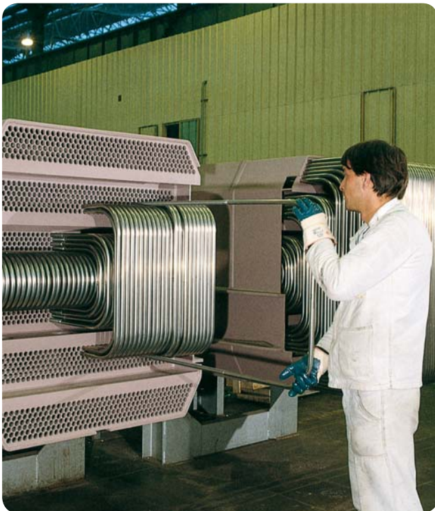
Wasserschleier/Zwischenüberhitzer aus 1.4510 (439), Europa.
