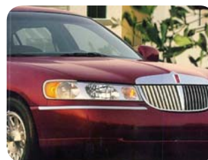
Kühlergrill und Zierleiste aus 1.4513 (436).
