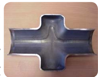
Hydrogeformtes geschweißtes Rohr (1.4003).
