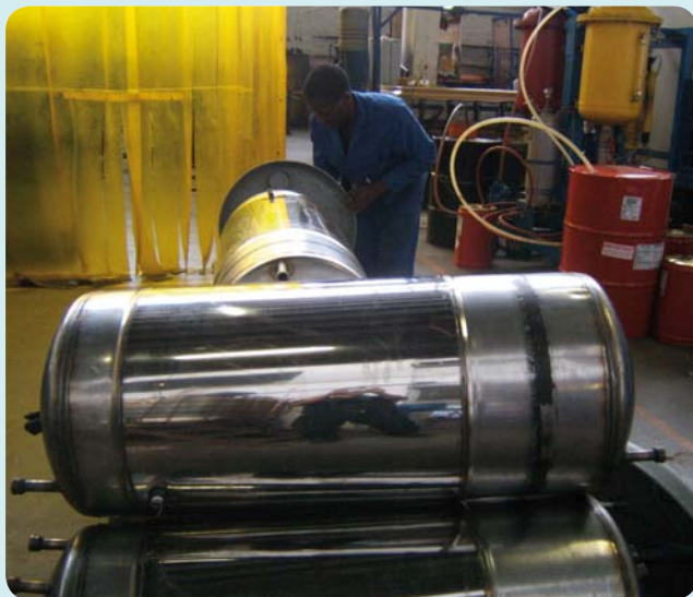
Geschweißter Tank aus 1.4309 (441), Sudairika.
