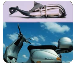
1.4509 (441), Centro Inox, Italien. Die neue Vespa ET2 ist mit einem Katalysator/Schalldämpfer aus Ferrit ausgestattet.
