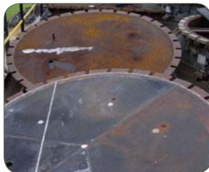
1.4003 (410), Columbus, Südafrika. Kohlenstoffstahl (oben) im Vergleich zu Ferrit (unten) nach 6 Jahren Betrieb.
