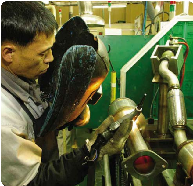
Geschweißtes Abgassystem aus 1.4510 [439], S. Korea.
