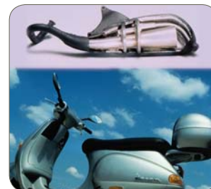
1.4509/441, Centro Inox, イタリア。新しい Vespa ET2 はフ ェライト系ステンレス鋼の触媒・ サイレンサーを装備しています。
