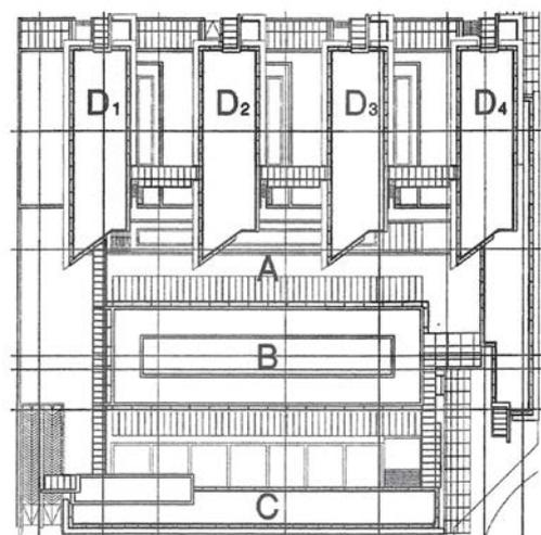
图片 3: 建筑平面图(B为既有建筑,C和Dn为新建建筑)
