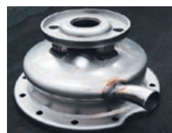
Die Verarbeitungsschritte umfassen Tiefziehen, Innenhochdruckumformung, Schneiden und Richten sowie das Einpassen.
