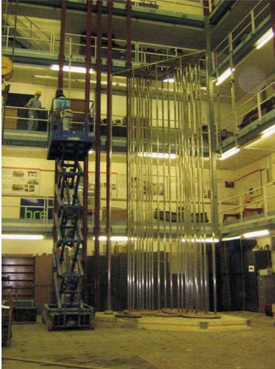
图 5: 在 BRE 建造的装饰亭部件等尺寸模型
