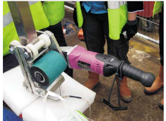
图 9: 现场抛光机(绰号“沿排水管爬上爬下的老鼠”)
